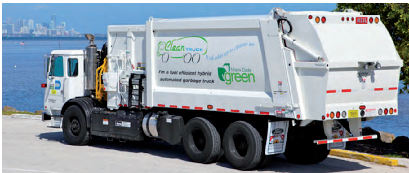
Foto mezzi di raccolta ibridi con recupero della frenata in uso nella Contea di Miami- Dude
