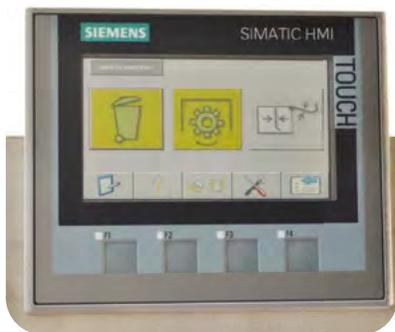
Quadro di controllo SIEMENS con sistema PROFINET
