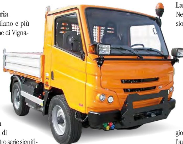
rispettare i severi parametri di inquinamento in tutte le condizioni di lavoro. L'ottima elasticità del motore da 3000 cc., eroga la coppia di 370 N.m. a partire da 1.230 giri. Con una potenza massima di 100 Kw (150 hp) a 3.500 giri.
