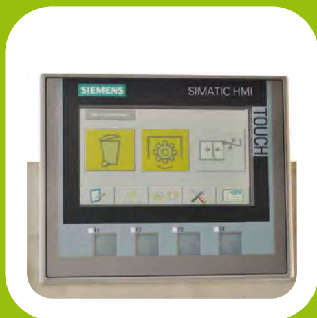
Quadro di controllo SIEMENS con sistema PROFINET
