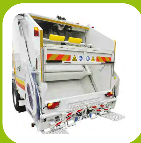
sistema pneumatico di apertura sponda per raccolta a mano
