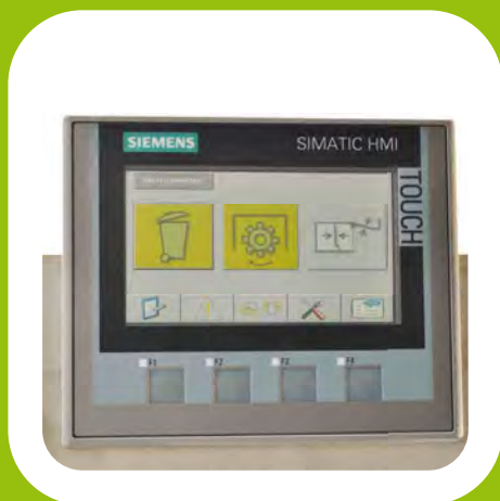
Quadro di controllo SIEMENS con sistema PROFINET
