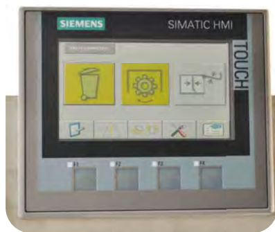
Quadro di controllo SIEMENS con sistema PROFINET
