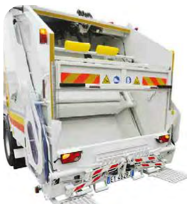
sistema pneumatico di apertura sponda per raccolta a mano
