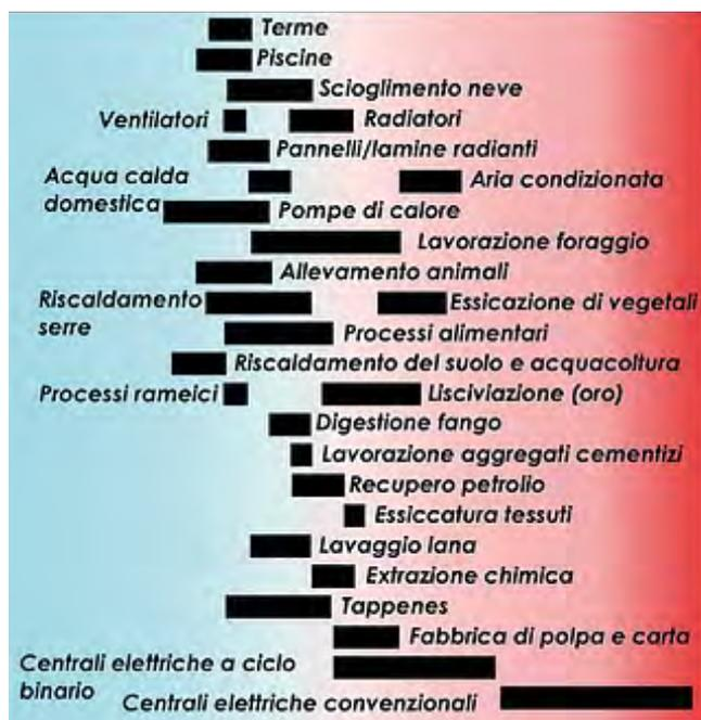
Principali usi della risorsa geotermica.
