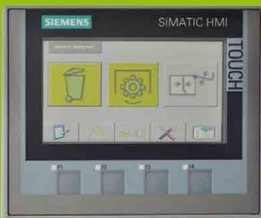
**Quadro di controllo SIEMENS con sistema PROFINET**
