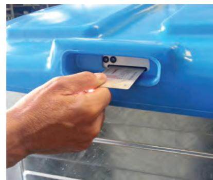
semplice prevede l'accesso limitato ad un numero di utenze tramite identificazione di un badge, la versione più performante memorizza gli svuotamenti effettuati e li trasmette al mezzo di raccolta con le funzioni di controllo operativo e funzionale del sistema.
