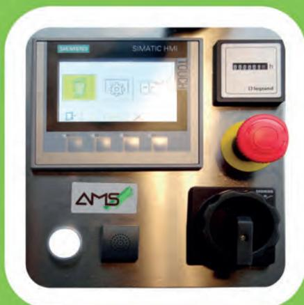
Quadro di controllo SIEMENS con sistema PROFINET
