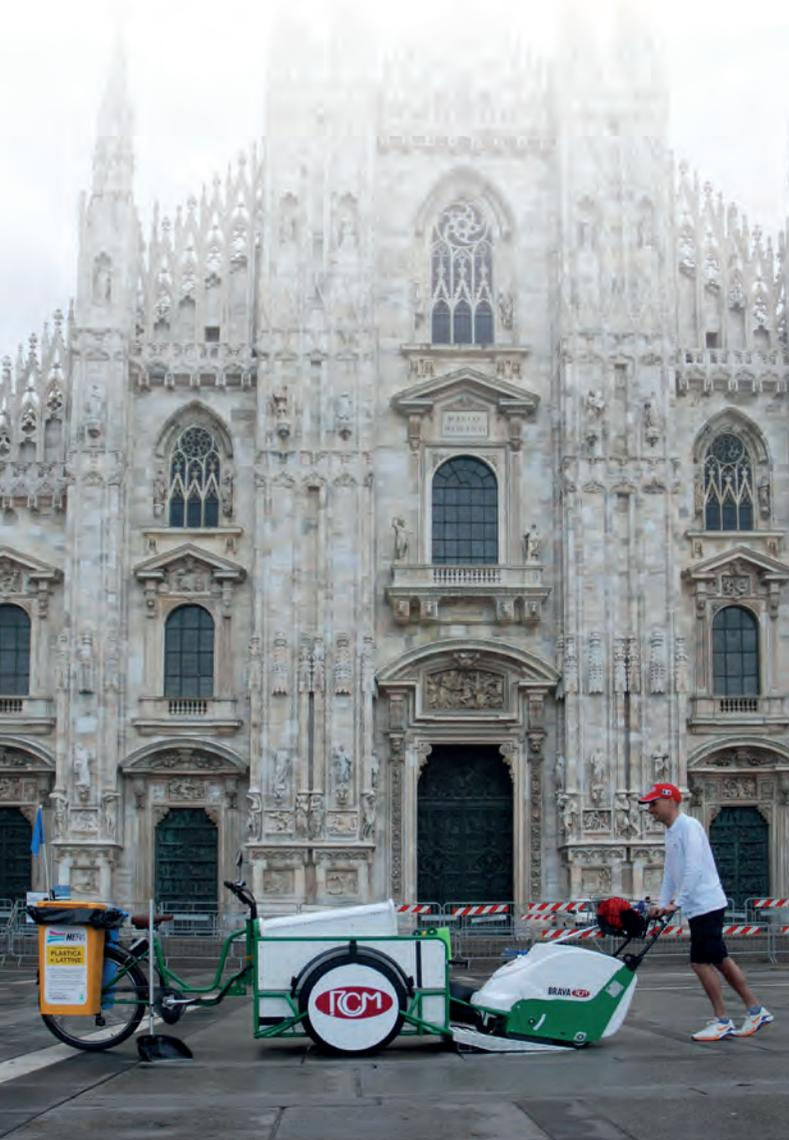
Un triciclo a pedalata assistita, con batteria al litio e pannelli fotovoltaici, trasporta una spazzatrice elettrica che raccoglie silenziosamente lo sporco e aspira la polvere.
