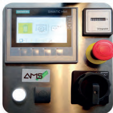
Quadro di controllo SIEMENS con sistema PROFINET
