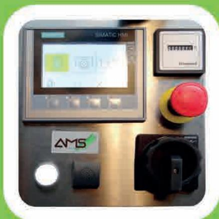
Quadro di controllo SIEMENS con sistema PROFINET
