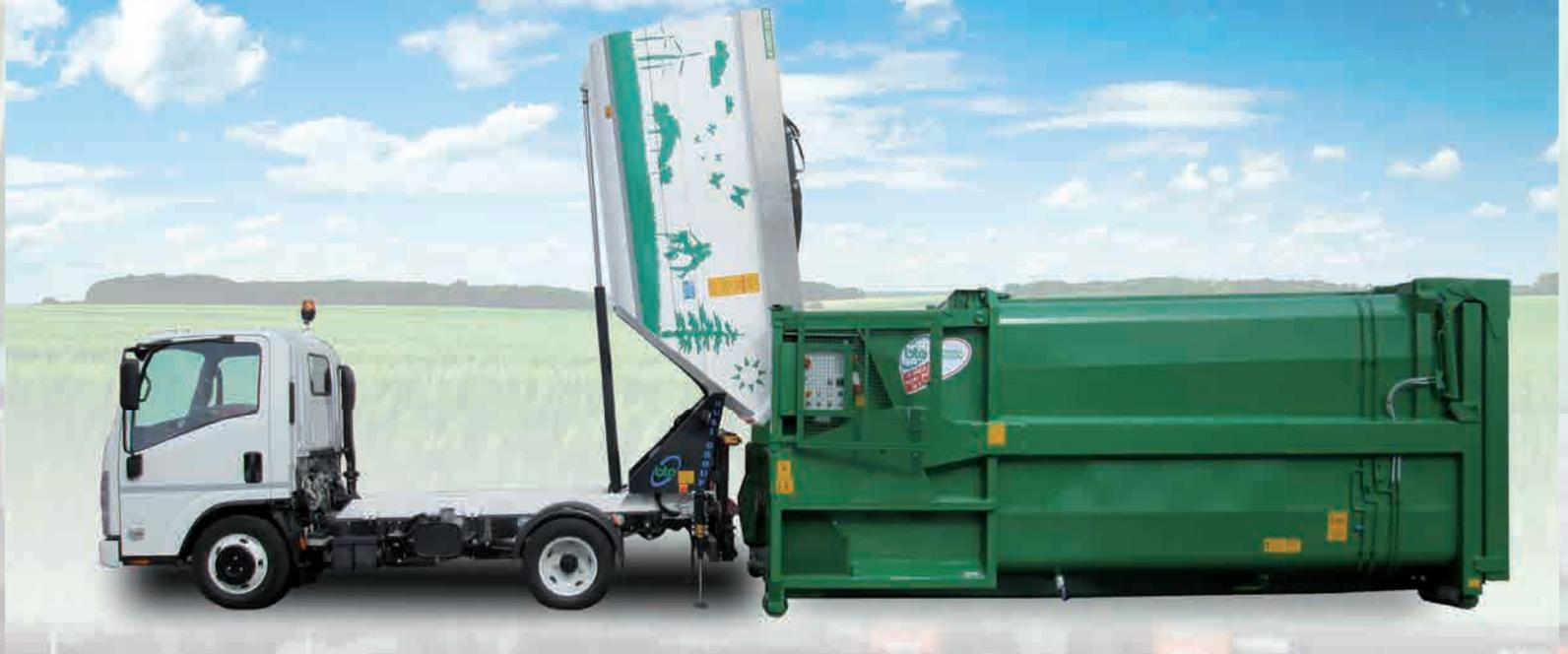
GRAZIE ALLE CARATTERISTICHE DIMENSIONALI E AD UN ANGOLO DI RIBALTAMENTO DI CIRCA 90° "VSC" E' UTILIZZATA PRINCIPALMENTE COME VEICOLO SATELLITE , PERFETTAMENTE ACCOPPIABILE CON COMPATTATORI.
