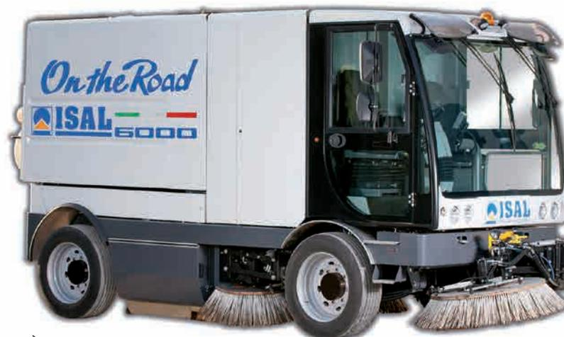
aspirante è composto da: spazzola principale a rullo, due spazzole laterali e convogliatore meccanico, tutto coadiuvato da un sistema di aspirazione con turbine e filtro per il controllo delle polveri. Esiste la possibilità di equipaggiare la spazzatrice con un filtro speciale "Green Filter" la cui particolarità è di essere idrorepellente, di contenere le polveri fini ed evitare dispersioni nell'ambiente.
