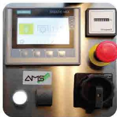
Quadro di controllo SIEMENS con sistema PROFINET
