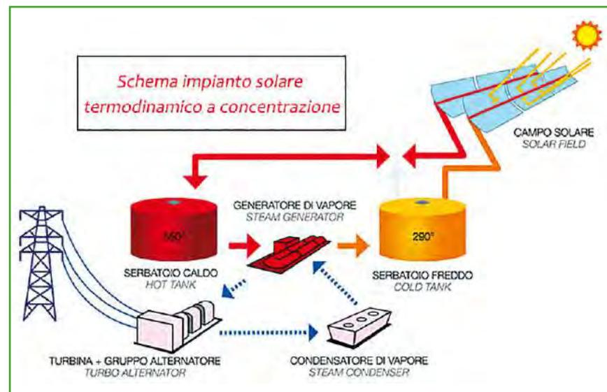
Mentre il termodinamico domestico viene normalmente utilizzato per l'acqua calda, nelle grandi centrali l'energia del sole viene trasformata in energia termica e poi convertita in energia elettrica.
