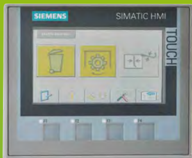
Quadro di controllo SIEMENS con sistema PROFINET
