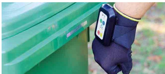
per leggere il tag RFID presente sul sacco o sul bidone, senza ulteriori tecnologie a portata di mano; per attivare le letture RFID è necessario premere solo il tasto predisposto alla lettura, di colore giallo.
