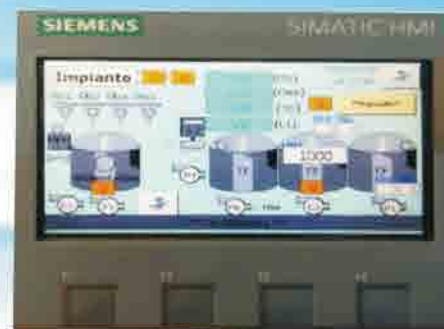
Gestione delle funzioni e dei dosaggi con PLC controllabile anche da remoto
