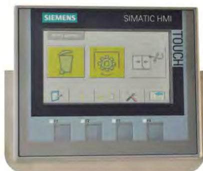
Quadro di controllo SIEMENS con sistema PROFINET
