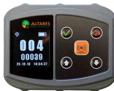
della frazione residua per l'applicazione della tariffazione puntuale. Per svolgere la lettura dei TAG, Acam Ambiente, si è dotata del sistema di lettura ArcoBEAT, un pratico e leggero strumento portatile che permette la lettura dei TAG, la georeferenziazione del punto di
