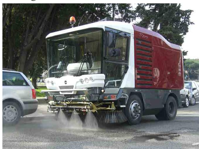
barra anteriore lavastrade ad alta pressione e una lancia a mitra collegata ad una ralla basculante e dotata di naspo con arrotolatore automatico; per le Mathieu nella serie MC210 Flex che prevede dei kit ad attacco rapido da in-
