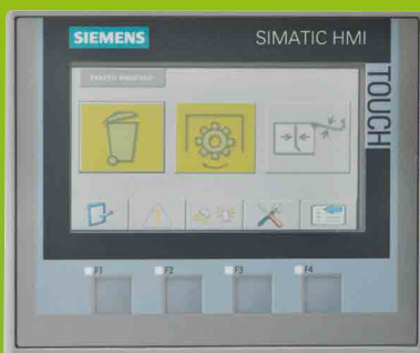
Quadro di controllo SIEMENS con sistema PROFINET
