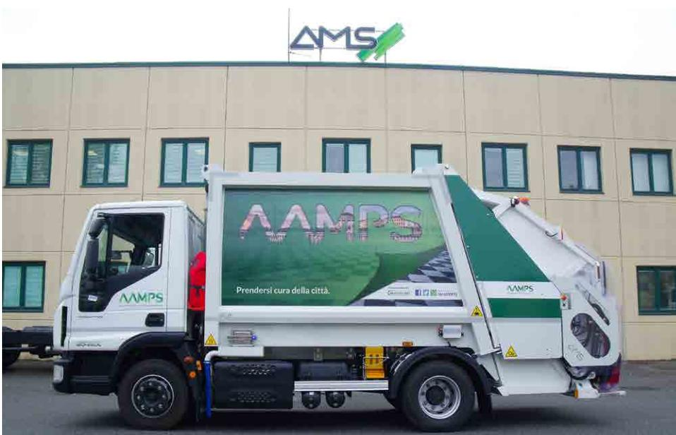
motore spento con azionamento della compattazione e del voltacassonetti in modalità elettrica, alimentato tramite batterie o tramite rete elettrica.
