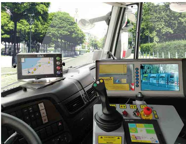
raccolto e l'eventuale TAG associato. HORUS-OBC-3 è in grado di espletare una funzionalità essenziale per la gestione dei contenitori informatizzati posizionati nel territorio servito. Tramite apposita antenna UHF 868 MHz il dispositivo permette di scaricare i dati relativi ai conferimenti registrati dal sistema di controllo accessi modello ID&A HORUS-ID
