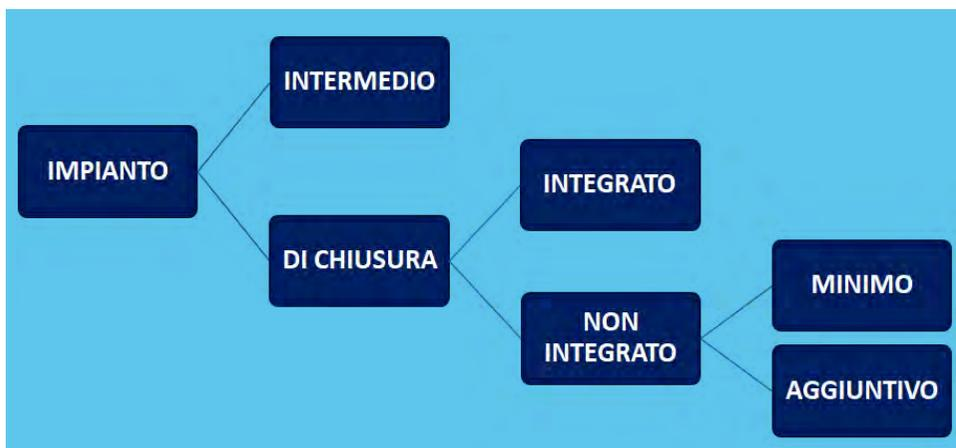
Figura 4.2 Sequenza logica per l'individuazione della classificazione degli impianti di trattamento secondo il MTR-2 (Utiliteam, 2021)
