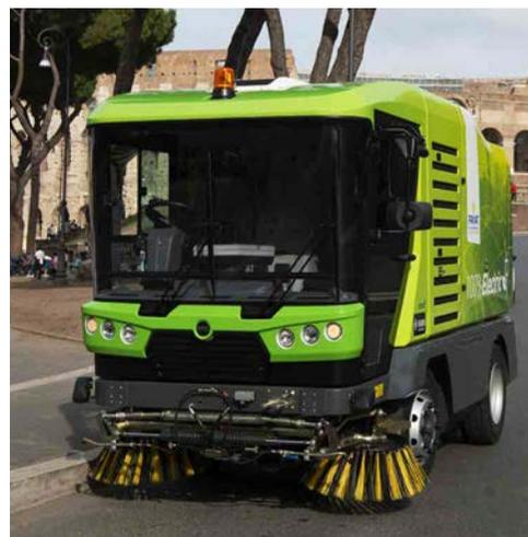
Sono previste due modalità di ricarica: Standard in meno di 4,5 ore (con questo sistema la macchina può essere caricata anche per un periodo di tempo più breve senza alcun impatto negativo sulla durata delle batterie; Rapida: in meno di 2 ore.
