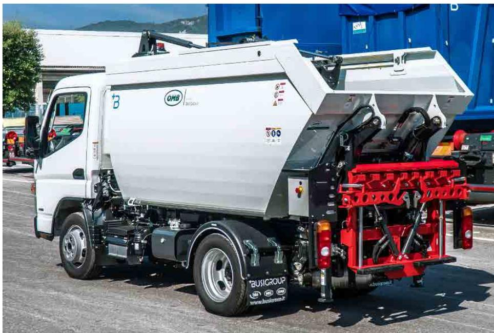
tori. Le vasche ribaltabili con costipatore pala-carrello sono realizzate in Domex per una maggior resistenza e durabilità e sono ideali per il sistema di raccolta rifiuti porta a porta. L'allestimento T-Rex per Ecoambiente comprende l'ultima tecnologia disponibile, tra cui un display di bordo a colori e sistema
