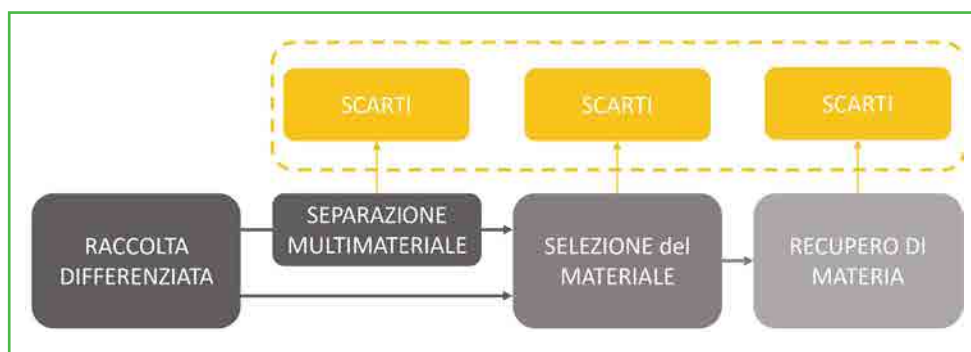
Figura 3 – Schema di flusso ideale del recupero dei rifiuti separati attraverso la raccolta differenziata (Bellan e Grosso, 2020).
