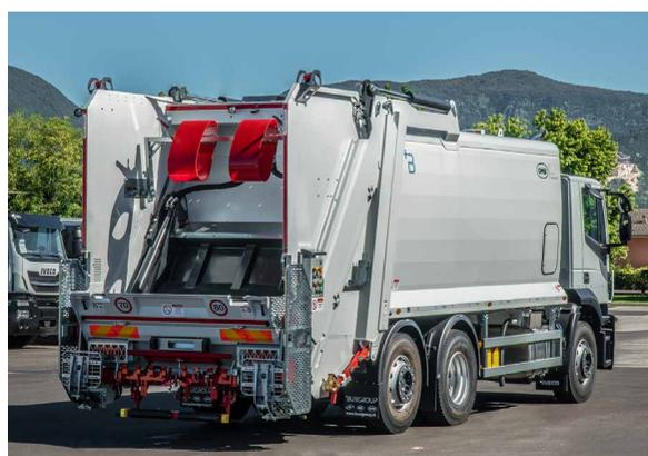
vasca con sistema di compattazione modello T-REX dalla capacità di 5mc e 7mc, ideali per la raccolta porta a porta e per una prima compattazione dei rifiuti; 3 veicoli con sistema di compattazione monoscocca a carico posteriore QUICK dalla capacità di 10mc, ideali per il supporto ai veicoli satellite nella raccolta porta a porta
