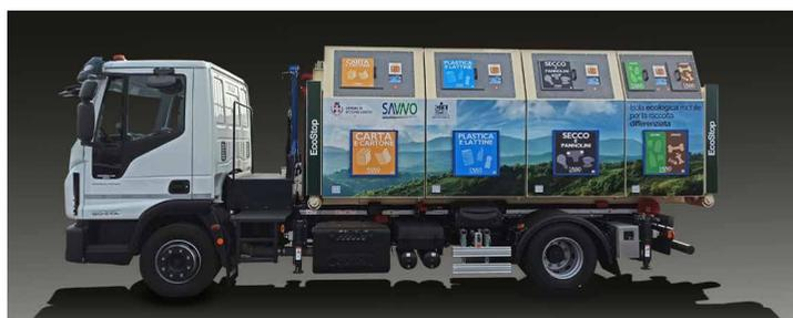
che consente la movimentazione tramite normali automezzi utilizzati per la raccolta. Lo svuotamento delle vasche avviene tramite un apposito kit ribaltatore modello ID&A EcoJolly, dotato di pistone, montato sull'automezzo a 2 assi che effettua la movimentazione dell'EcoStop.
