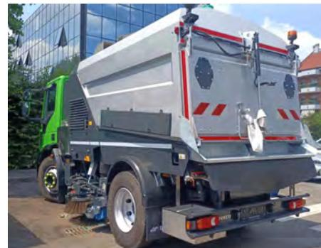
to di tipo idraulico, l'allestimento Aebi Schmidt risulta compatto privilegiando il montaggio su autotelai a passo ridotto.
