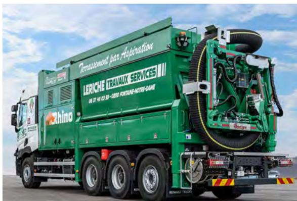
dispositivo è in grado di aspirare materiali sia secchi che liquidi mantenendo una pressione leggera sul suolo, al fine di evitare danni agli elementi presenti nel sottosuolo.
