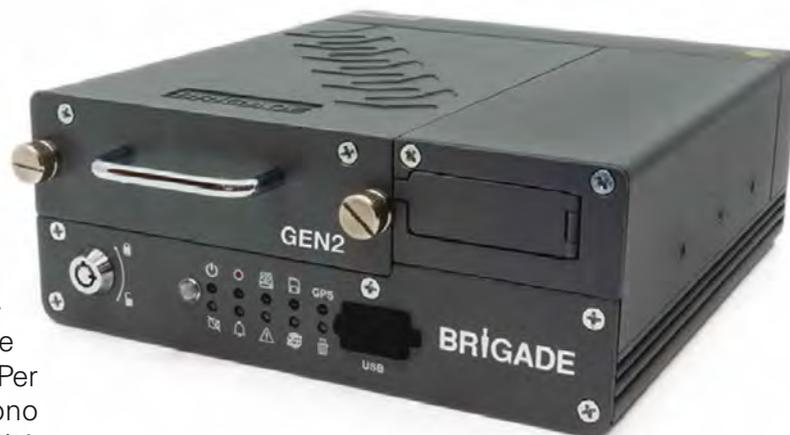
gli MDR registrano anche la velocità e la posizione, mentre l'accelerometro incorporato fornisce dati su impatto, accelerazione e frenata. Sono dunque utili sia per valutare le dinamiche di sinistri, tamponamenti, urti, danneggiamenti etc, sia come deterrente per furti e atti di vandalismo.
