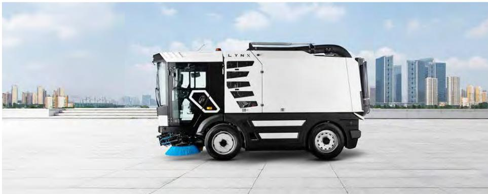
trice VS6e, un'innovativa attrezzatura autocarrata completamente elettrica, con capacità di 6 mc., montata su telaio elettrico Foton, noto per la sua potenza e affidabilità.
