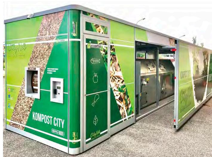
di organi meccanici in movimento all'interno della camera di compostaggio. Questa scelta semplifica la tecnologia, riducendo i fermi macchina dovuti a rotture o blocchi causati da oggetti estranei.
