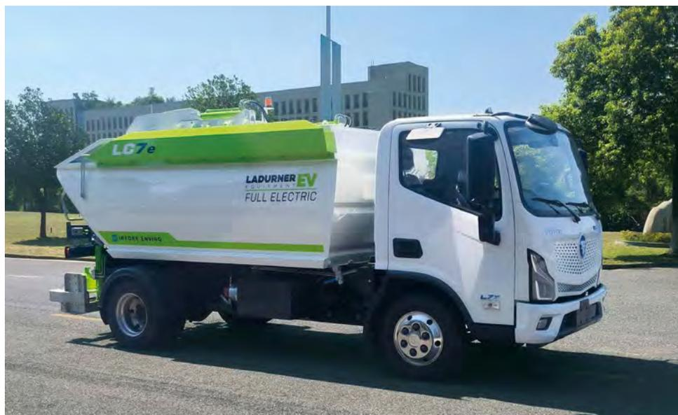
alle sue dimensioni ridotte e alle caratteristiche tecniche studiate ad hoc. Con una massa totale a terra di 4,25 tonnellate, rientra nella categoria N2, ma può essere guidato con patente B, offrendo così maggiore accessibilità per i conducenti e ampliando le possibilità di utilizzo in contesti cittadini stretti e complessi.
