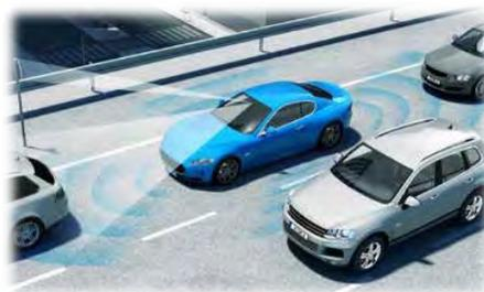
avvisare il conducente, con sistemi ottici ed acustici e successivamente ad intervenire sul sistema frenante del veicolo al fine di evitare l'impatto;
